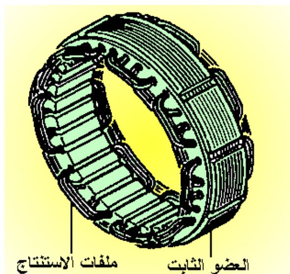
الشكل ( ٢ - ٤٨ ) يبين أجزاء العضو الثابت للمولد
